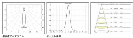
光度分布曲線/遠方の照度 (消費電力18W、配光角52°)
